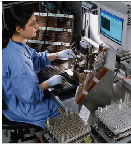
Moderne Dieseleinspritzsysteme müssen höchsten Qualitätsansprüchen genügen. Prüfung an Bauteilen für Common-Rail-Injektoren im Werk Bursa (Türkei).
